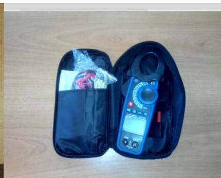
Рис.20.Асм-2368 токовые клещи-мультиметр
