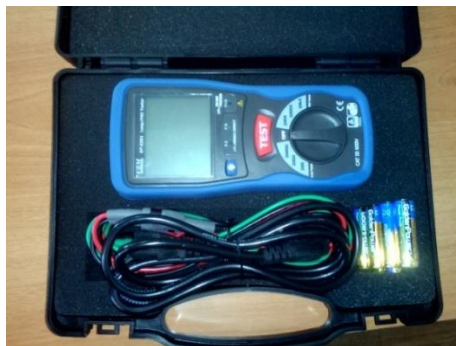
Рис. 19. DT-5301 измеритель сопротивления петли фаза-нуль
