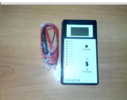
Рис. 22.Квант-К прибор определения замыканий
