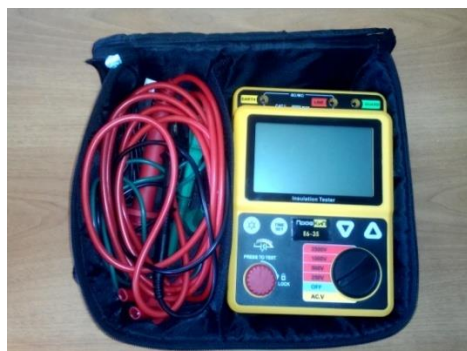
Рис. 21.Е6-35 мегаомметр цифровой
