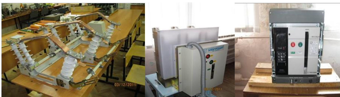
Рис.16. Наглядные образцы разъединителя, вакуумного выключателя, автоматов предоставлены фирмой ООО «ТД «Электрощит» - Самара»
